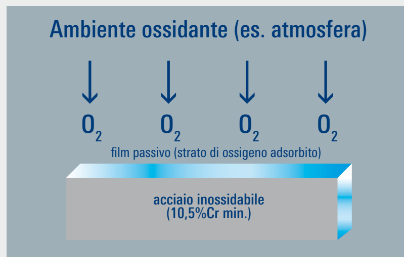
Gli acciai inossidabili sono leghe a base di ferro, cromo e carbonio. Stainless steel is an alloy with a basis of iron, chrome and carbon in addition.
