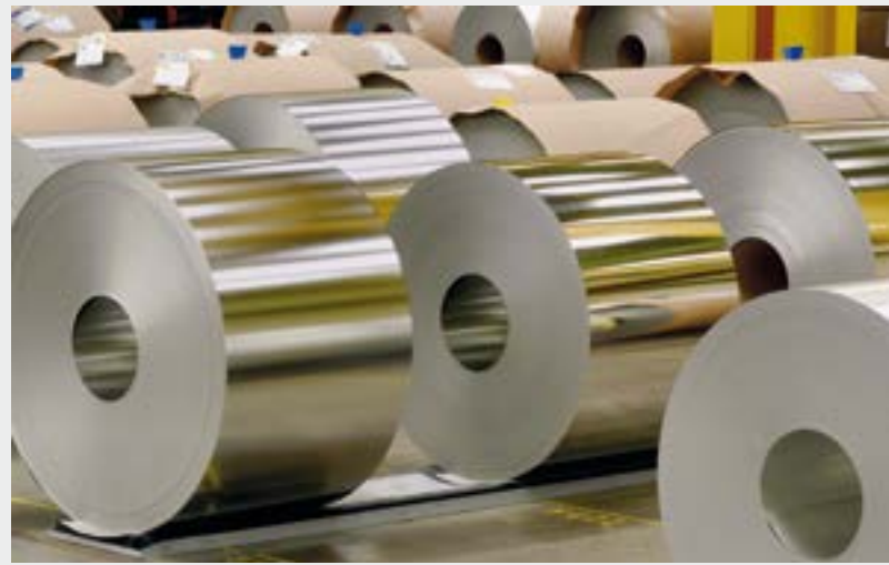
Gli acciai inossidabili sono leghe a base di ferro, cromo e carbonio. Stainless steel is an alloy with a basis of iron, chrome and carbon in addition.
